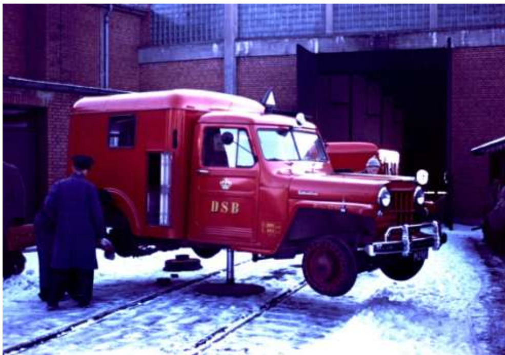
Jernbanehjul / landevejshjul under montering.
